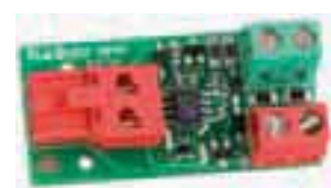
Interfaccia BUS XIB (nel caso si utilizza la scheda E024S con fotocellula non BUS)
